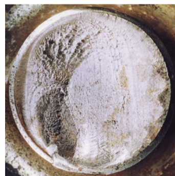
図3 疲労破面の例（ボルトの破損例）
