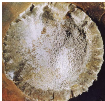
図3 疲労破面の例（ボルトの破損例）
