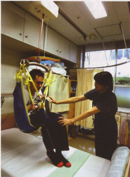
天井リフターを使用している様子
