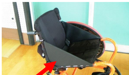
側板（ハードサイドレザ：金属板をビニールでコーティング）
