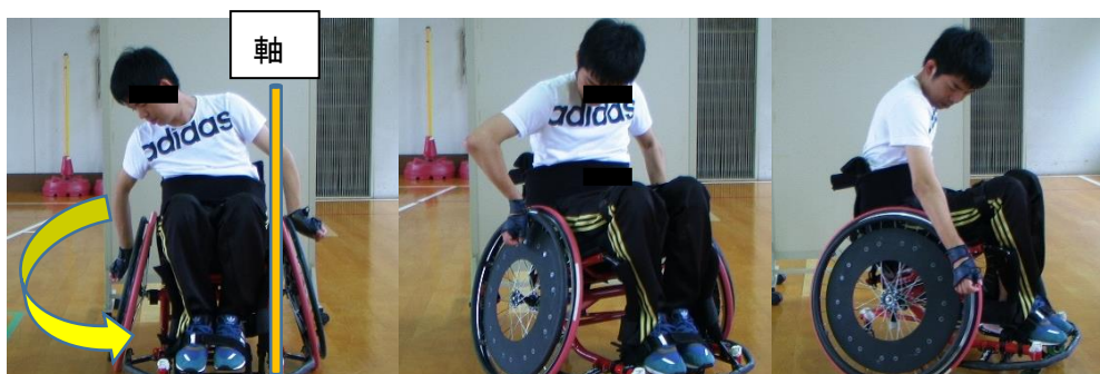
ブレーキ側のタイヤが軸になって旋回します
