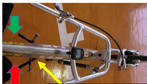
トラックレバー（赤方向にたたくと右に緑方向にたたくと左に舵が切れる
