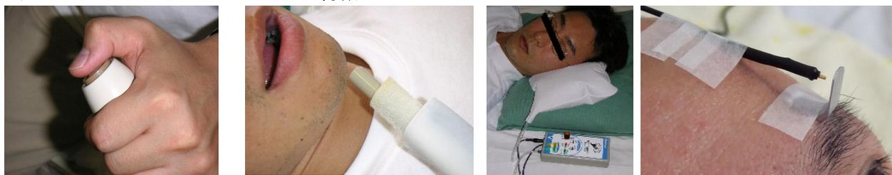
左から順に、握り（通常）スイッチ、タッチセンサー、エアバッグスイッチ、ピンタッチスイッチと呼び、運動機能障害の進行とともにこの順番で導入する傾向があった。しかし、残存する微かな随意運動が、患者によって遠位から近位への動きか、その逆かに大別されることに気がつき、握りスイッチを代表とする押しボタンスイッチは、曲げる（遠位から近位）方向の力を拾い、体の表面から離れた位置に設置するタッチセンサーは伸ばす（近位から遠位）方向の力を拾うという運動方向の特徴で使い分けると初期から全経過に於いて患者の負担は少ないという発見に加え、さらに数ミリ程度の微小な動きを感知することも画像スイッチで駆使可能となり、力強くスイッチ支援を展開していた。
