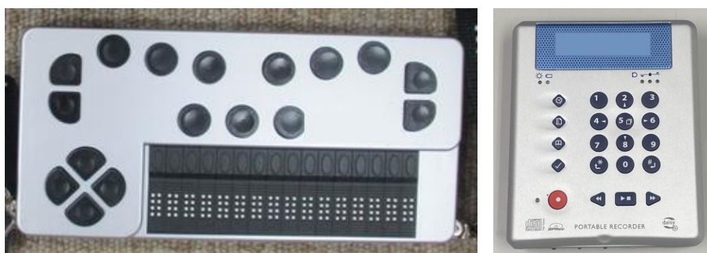
図5 左：携帯点字ディスプレイ、右：DAISY プレイヤー
