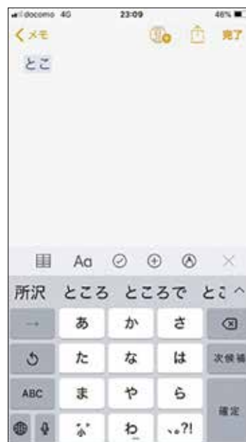
図4 予測変換機能の例 “とこ”と入力しただけで、辞書や入力履歴から“所沢”“ところ”、“ところで”などの候補が表示されるので、選択するだけで語を確定できる。
