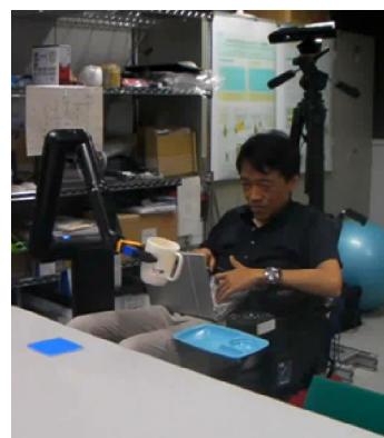
図3 電動車椅子にロボットアームを設置したシステム
