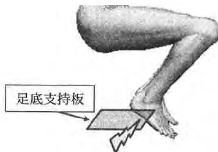
図2 尖足変形がある場合の標準型車いすの足底支持板と足底の接触
