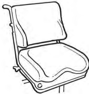
図15 採形により作成したモールド型座背支持部
