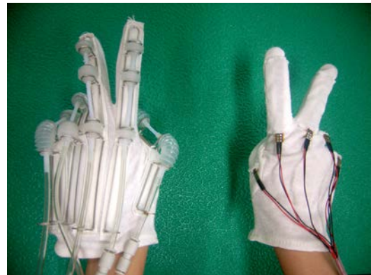
写真3 健全な右手にセンサグローブをはめて、各指を任意に動かすと、パワーアシストハンドにより麻痺した左手の各指が同じように動かされる
