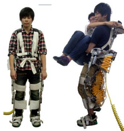
図1 エアバッグ式簡易型パワーアシストスーツ
