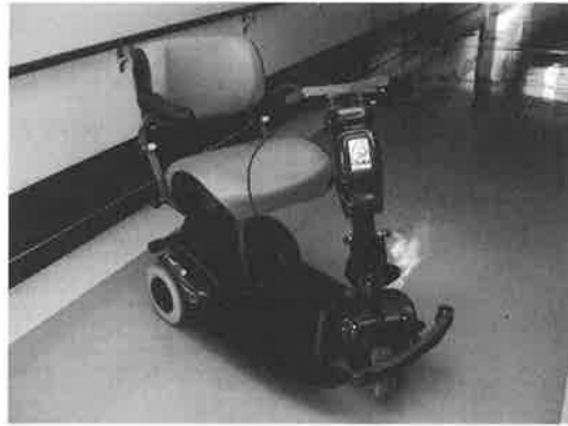
図8 3輪スクター型電動車いす
