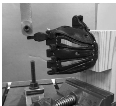
図2 3D プリント造型義手部品の強度試験 (左) と示指の基節部品 (右) (太線が積層面方向を示す。)
