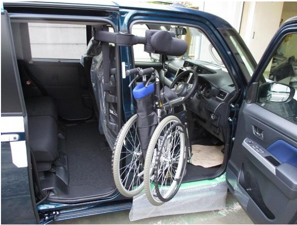
図 23 車椅子積載装置（車内収納）
