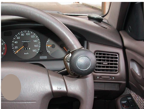
図18 ハンドルの真上に取り付け
