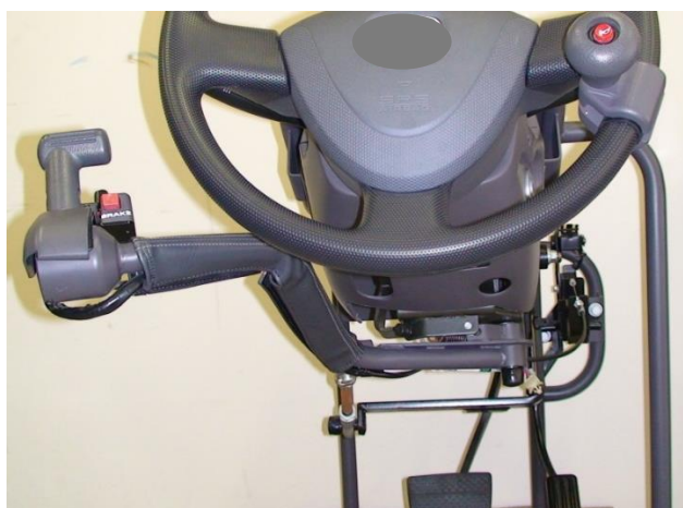
図15 コラムタイプの手動装置
