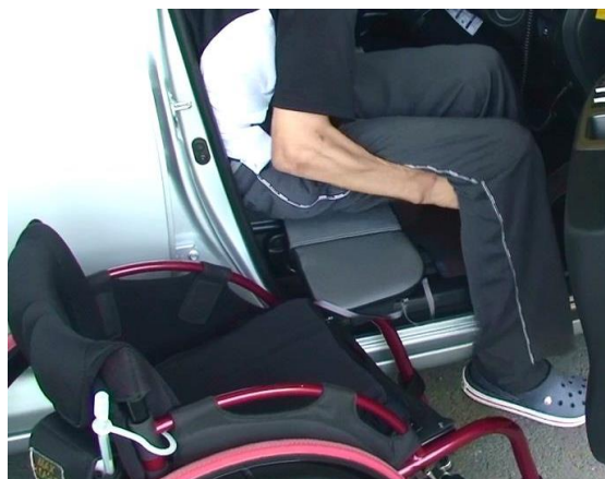
図 7d 移乗ボード付シート（展開時）
