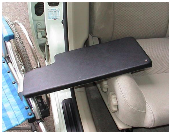
図 7a トランスファーボード使用例
