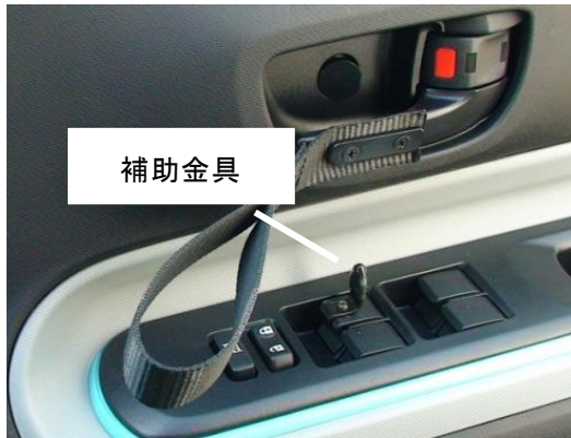
図 27 パワーウインドスイッチ補助金具
