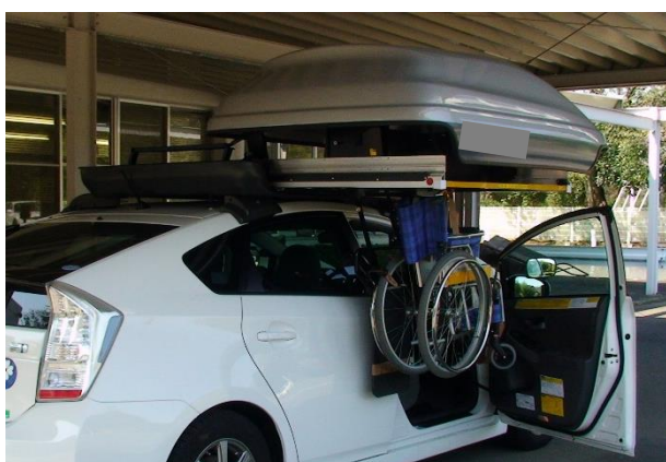
図 21 車椅子積載装置（スライド収納）
