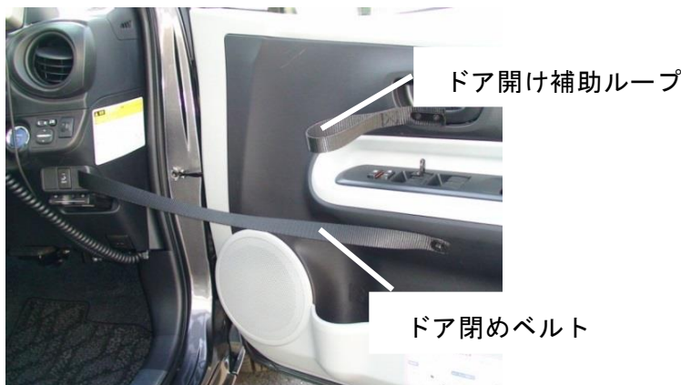
図26 ドア閉めベルト、ドア開け補助ループ
