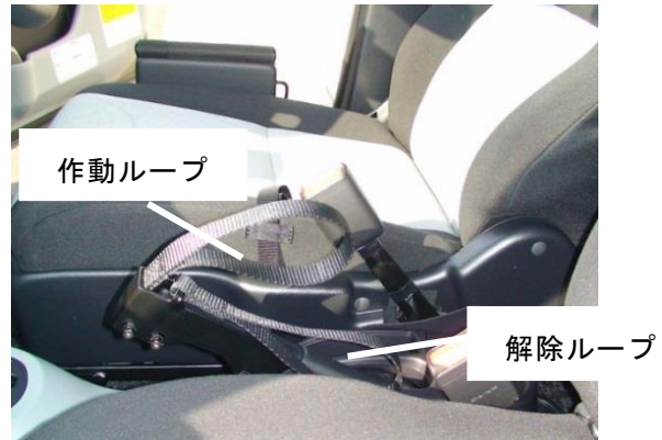
図 28 ブレーキレバー補助ループ
