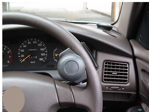
図19 ハンドルの内側に取り付け
